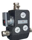
Unité de charge Laddomat avec cartouche de 72°C pour assurer un retour chaudière à 65°C et la protéger contre la corrosion acide.
